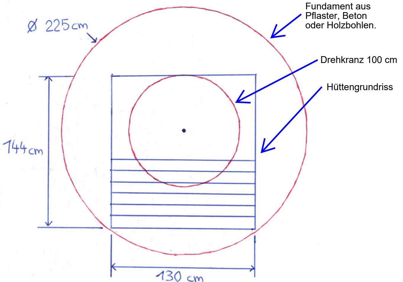
Die Arretierungsflasche am Drehkranz in Richtung Westen platzieren, damit der Hüttenfaulenzler bei Nichtbenutzung nur von hinten bewittert wird. Die beiden Befestigungsflaschen am Drehkranz sind zum Verankern mit z.B. Betonschrauben auf dem Untergrund vorgesehen.
